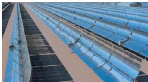
Εικόνα 2: Το σύστημα του παραβολικού συλλέκτη [4]
