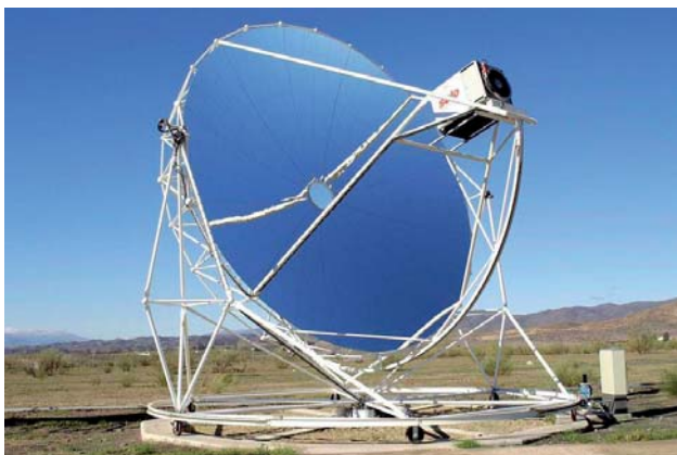
Εικόνα 5: Πρωτοπόρο σύστημα ηλιακού δίσκου [4]
