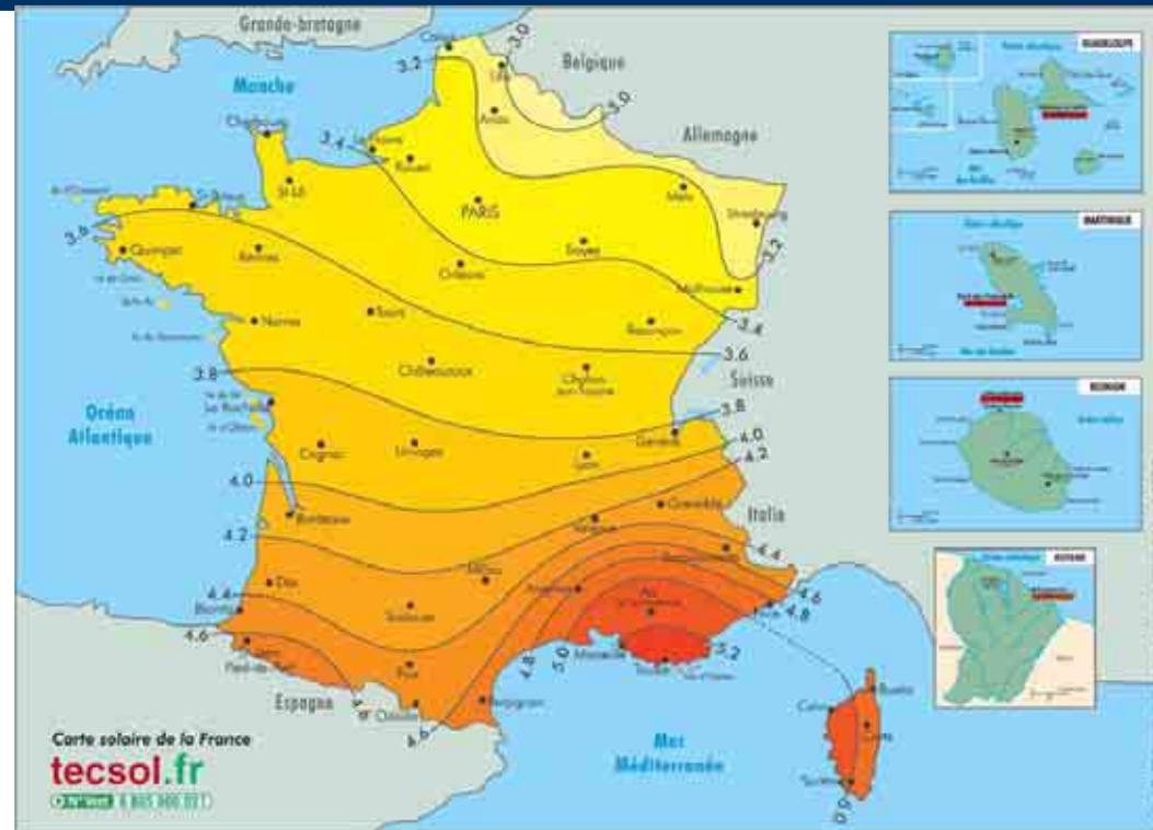
Moyennes annuelles de l'énergie reçue sur une surface orientée au sud et inclinée d'un angle égal à la latitude (en kWh/m<sup>2</sup> jour).
